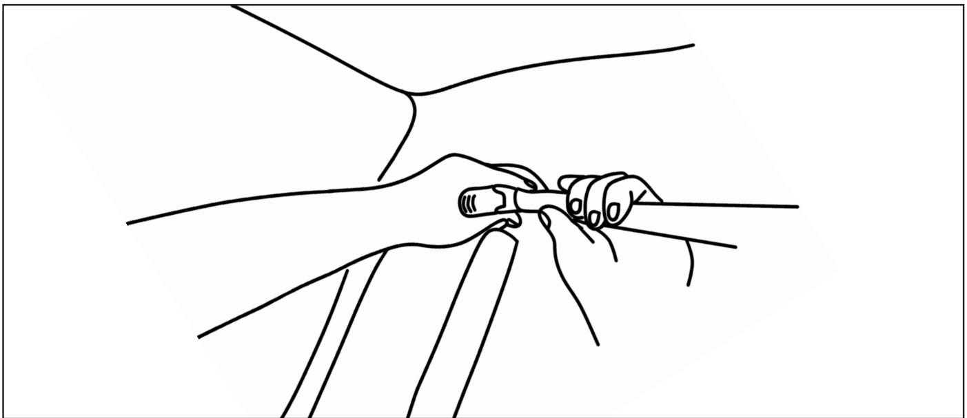
**6.** Länge der Teleskopstange einstellen, bis genügend Spannung erreicht ist, und Verschluss fixieren. | Adjust the length of the telescopic pole until sufficient tension is achieved, then secure the lock.
