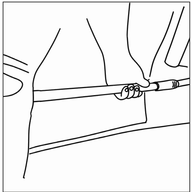
**5.** Teleskopstangen im Zelt an dem U-Bügel und an der dafür vorgesehenen Haltestange einhängen | Attach the telescopic pole inside the tent to both the U-frame and the designated support bar.
