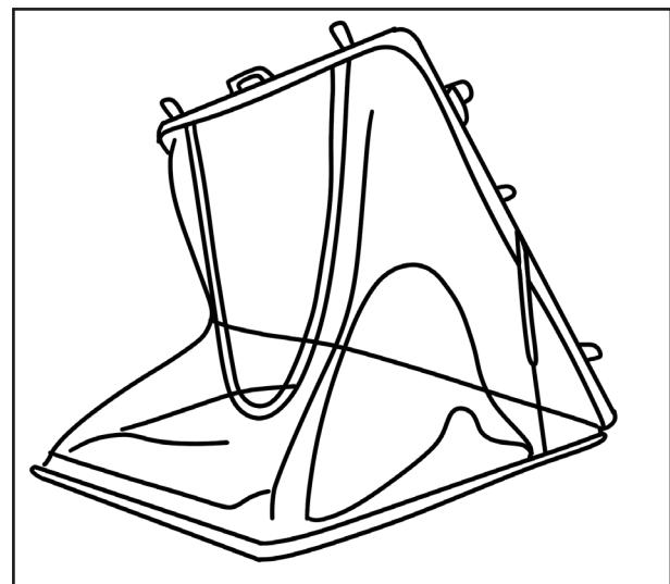
**3.** Gummiseil im vorgesehenen Kanal an der Hartschale verstauen. | Stow the elastic cord in the designated channel on the hard shell.
