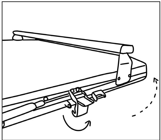
1. Alle vier Verschlüsse an der Hartschale öffnen. | Open all four latches on the hard shell.
