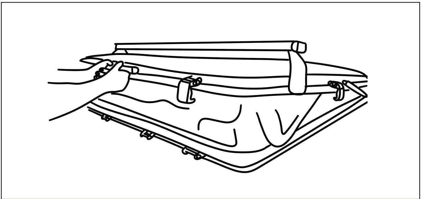
2. Schale nach oben anheben, bis die Stabilus-Gasdruckfedern ausgefahren ist. | Lift the shell upwards until the Stabilus gas struts are fully extended.
