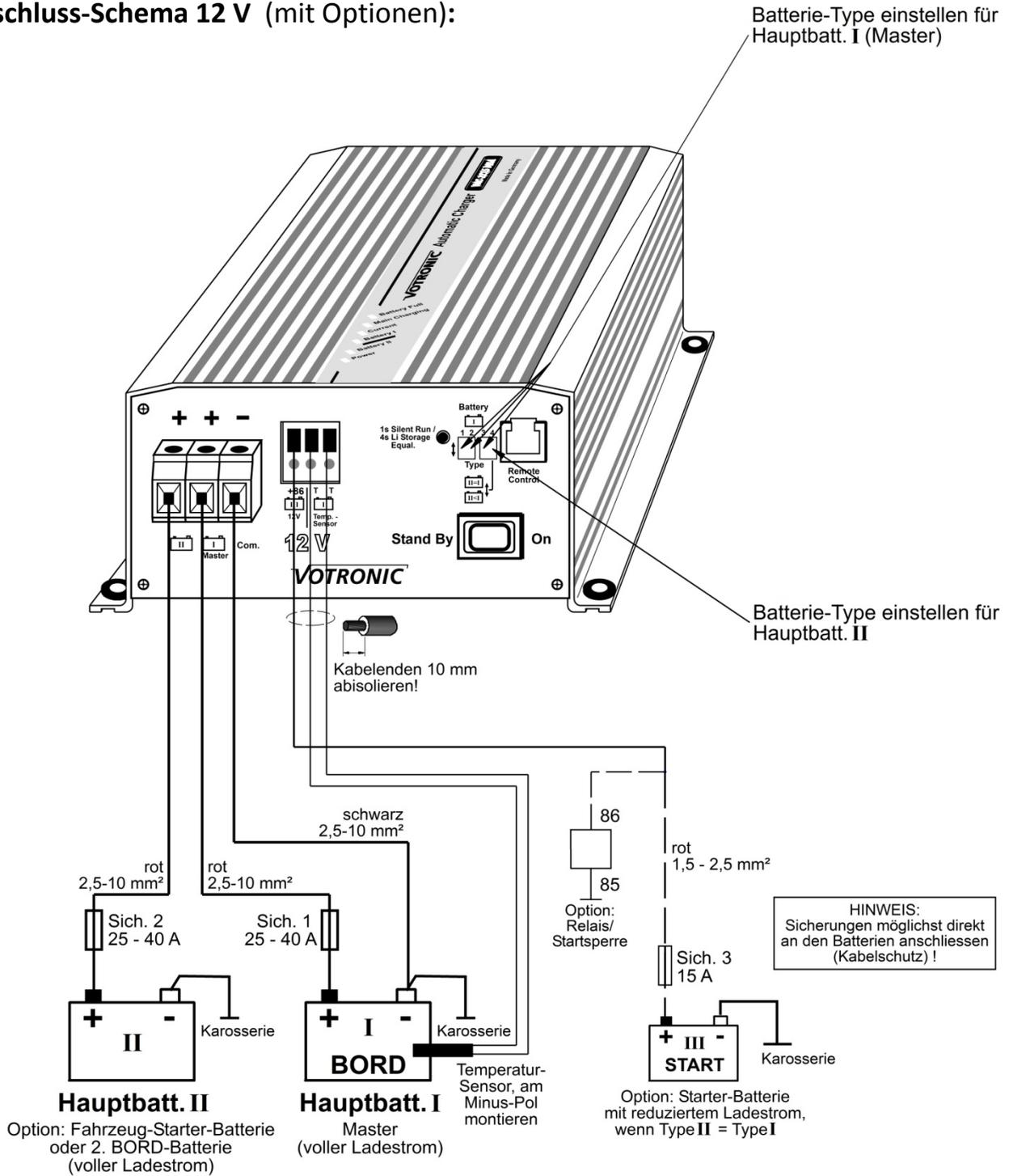
Hinweis: Das Gerät arbeitet aus Sicherheitsgründen bei LiFePO<sub>4</sub>-Batterien **nur** mit angeschlossenem Temperatur-Sensor (im Lieferumfang)! Sensor am Minus-Pol der Batterie anschrauben.
