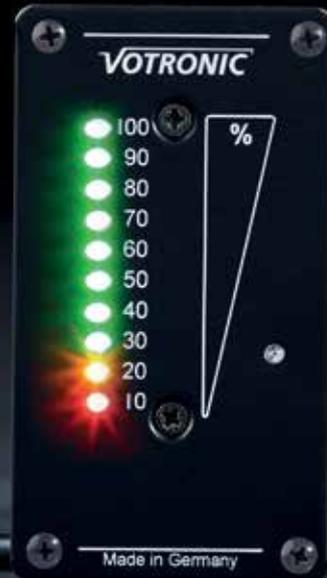
Das LED Tank-Display HE wurde speziell für den rauen Einsatz in Feuerwehr-Fahrzeugen konzipiert und dient zur genauen Anzeige des Lösch tanks im Fahrzeug. Es ist als Panelversion für den Einbau in Anzeigetafeln vorgesehen und mit zwei genormten Messsignalen (0...10 V bzw. 4...20 mA) erhältlich. Damit ist das Gerät nicht nur für den VOTRONIC Tank-Sensor FW verwendbar, sondern kann auch an Messwertgebern anderer Hersteller mit gleichen Normsignalen betrieben werden.
