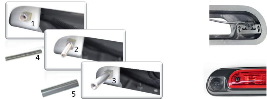
1. Setzen Sie die Kamera von der Konsolen-Rückseite in die Öffnung der Konsole ein. Kamera mit den beiden Schrauben an der Konsole befestigen.
