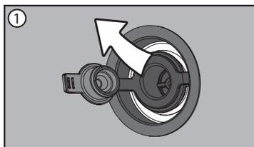
Než matraci začnete nafukovat, otevřete vnější uzávěr a zatáhněte za lanko, aby vyčínalo.
