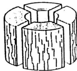
Dachverstärkung in Form eines Holzringes
