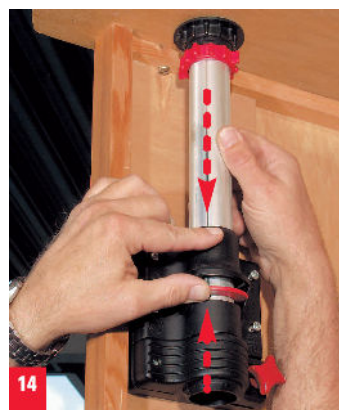
14. Automatik-Klemmplatte nach oben drücken und Antennenrohr einführen.
