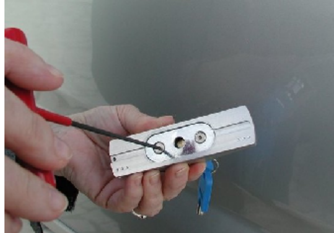
6 - Schliesszylinder anbringen und festziehen
