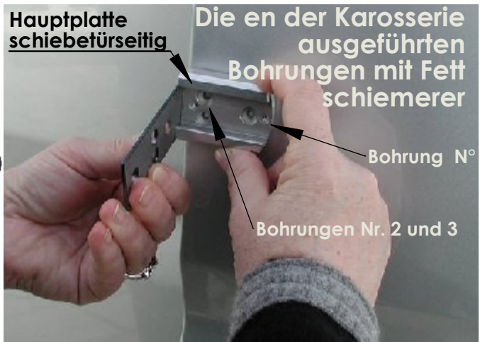
2 - Die Hauptplatte an der Türkante positionieren (die, die angeschraubt wird) Bohrung Nr.1 anzeichnen und mit Ø 5 ausführen und Niet anbringen
