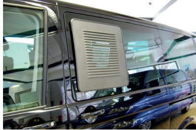
Der Lüftungseinsatz für Schiebefenster eignet sich ebenfalls hervorragend zur Versorgung des Fahrzeugs mit Frischluft. Genau wie der Frischlüfter ist auch er mit einem Moskitonetz ausgestattet, durch die Belüftungskiemen selbst dringt kein Regenwasser ein.
