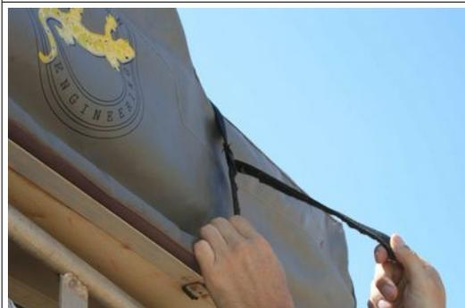
Öffnen Sie die Befestigungsriemen sowie den Reißverschluss an allen 3 Seiten der Reiseabdeckung.
