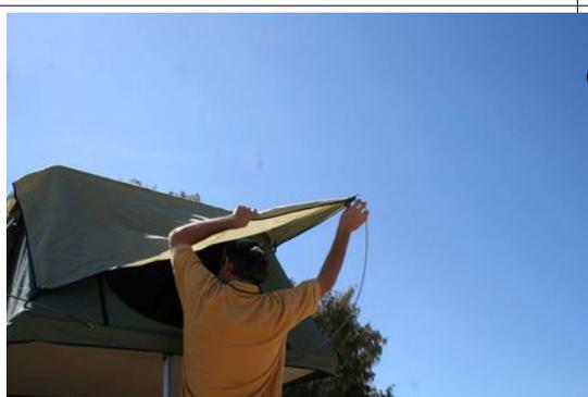
Biegen sie das Gestänge nach oben und führen sie den Hacken in die Öse der Überzeltes ein.
