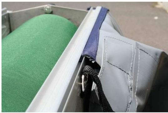
Führen sie die Reiseabdeckung in die Kederschiene ein und befestigen Sie die verbleibenden 3 Seiten mit dem Reißverschluss.
