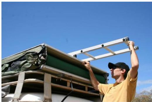
Ziehen Sie die Leiter aus bis die Sicherheitspins einrasten. Unter Umständen müssen Sie die Sicherheitspins manuell einlegen.
