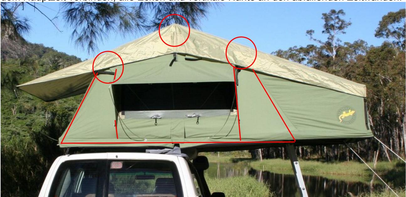
Verwenden Sie hochqualitativen Nahtversiegeler den Sie mit einer kleinen Bürste (Zahnbürste oder ähnliches) von beiden Seiten in die absolut trockene Naht einbürsten. Es ist eine ausreichende Menge an Versiegeler zu verwenden um sicherzugehen, dass die Naht vollkommen durchtränkt wurde. Der Nahtversiegeler wird in eine flexible aber wasserdichte Membran aushärten und die Naht schützen.
