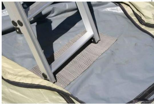
Um Schäden am Boden zu verhindern sollte die Leiter immer auf der vorgesehenen Schutzmatte aufliegen.
