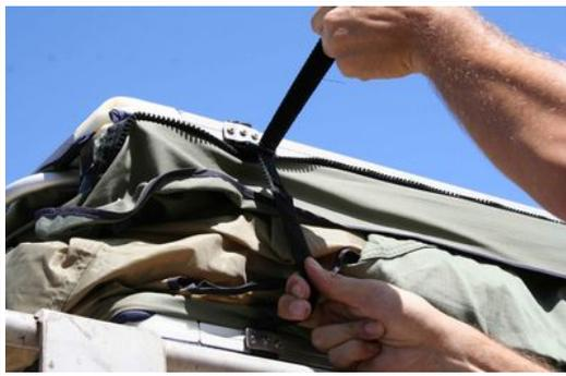
Öffnen Sie die Zugriemen an beiden Seiten.
