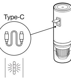
Utilizzare il cavo Type-C per la ricarica. Quando si collega il cavo, le luci si accenderanno in base allo stato della batteria. Quando è completamente carico, le luci si spegneranno dopo 1 minuto.
