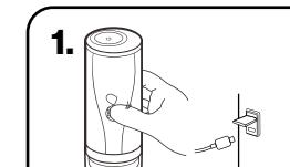
Verificare prima lo stato della batteria, premere una volta il pulsante per visualizzare lo stato della batteria. Quando è in modalità di ricarica, le luci iniziano a lampeggiare. Quando è completamente carica, tutte le luci sono accese e si spengono dopo 1 minuto.
