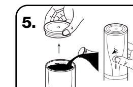
Aprire il coperchio, riempire con acqua fredda o calda, chiudere il coperchio. (non superare il limite della scala)
