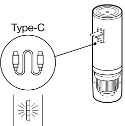
Utilisez un câble Type-C pour le chargement. Lors de la connexion au câble, les voyants s'allumeront en fonction de l'état de la batterie. Une fois complètement chargé, les voyants s'éteindront au bout d'une minute.
