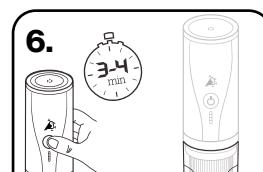
Estrazione a caldo: Necessita di riscaldamento. Premere e tenere premuto il pulsante per 2 secondi, il Coffeebird emette un bip e inizia a riscaldarsi. Dopo 3-4 minuti, l'apparecchio emette un bip, indicando che il riscaldamento è terminato, quindi inizia immediatamente l'estrazione.
