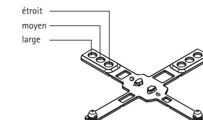
3. Lorsque l'ensemble de la surface a été préparée, assemblez les croisillons dans la position souhaitée en appuyant avec force pour enfoncez. Pour ce faire, veuillez utiliser l'outil fourni (aide au montage). Veuillez ne jamais utiliser un marteau ou un outil similaire pour l'assemblage.
