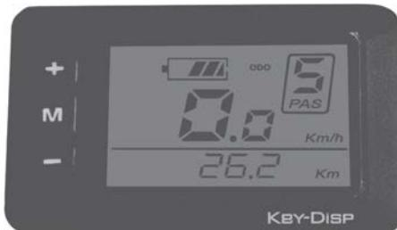
Řídící jednotka je integrovaná s LC displejem a ovládá pohonný systém. Je umístěna na řídítkách.
