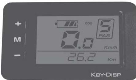
Sterownik jest zintegrowany z wyświetlaczem LCD i steruje systemem napędowym. Zamontowany jest na kierownicy.
