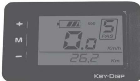
De besturingseenheid is geïntegreerd in het LC-display en bedient het aandrijfsysteem. Deze bevindt zich op het stuur.
