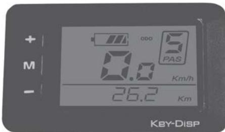
L'unità di controllo è integrata nel display LCD e gestisce il sistema di azionamento. È situata sul manubrio.
