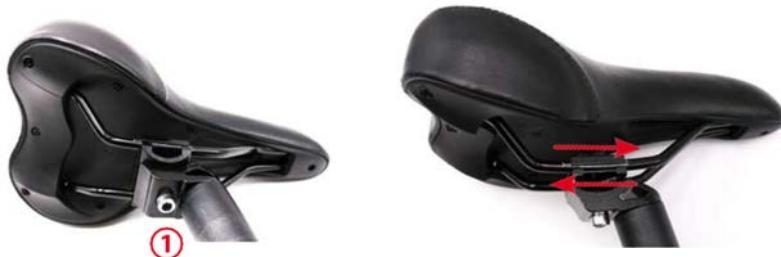
**SIKKERHEDSBEMÆRKNING:** Sædeposten har en MAX-mærket linje (det er sikkerhedslinjen), det er den maksimale højde, du kan hæve sadlen. I alle tilfælde af justering skal MAX-mærket linje altid være under sædepostens klemme. Du kan blive utsat for alvorlig skade, hvis sadelhøjden hæves ud over MAX-linjen.
