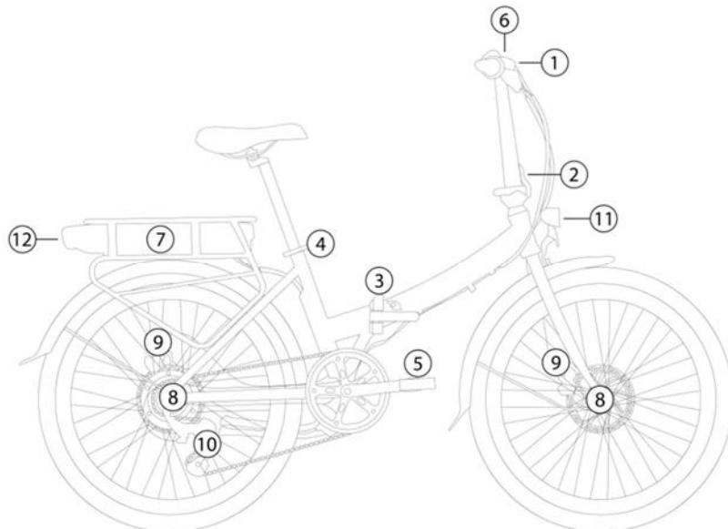
① Guidon (selon le modèle avec déblocage rapide pour le réglage en hauteur)
