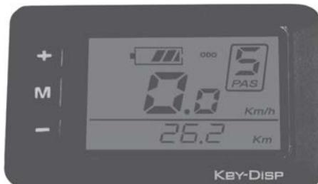
Kontrollenheten är integrerad med LC-Displayn och samordnad med driftsystemet. Den är placerad på styret.
