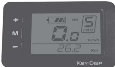
L'unité de contrôle est intégrée avec un afficheur LC et elle contrôle le système de transmission. Elle est située sur le guidon.
