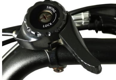
Beim Aufsteigen auf das Rad muss der Schwenkmechanismus blockiert sein, der Hebel muss hierzu wie auf der Abbildung auf LOCK stehen.
