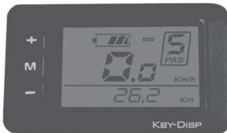
Kontrolenheden er integreret med LCD-displaye tog driver drevsystemet. Den er placeret på håndtaget.
