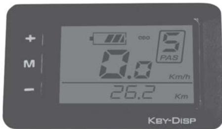
Η μονάδα ελέγχου είναι ενσωματωμένη στην οθόνη LC και λειτουργεί το σύστημα κίνησης. Βρίσκεται στο τιμόνι.
