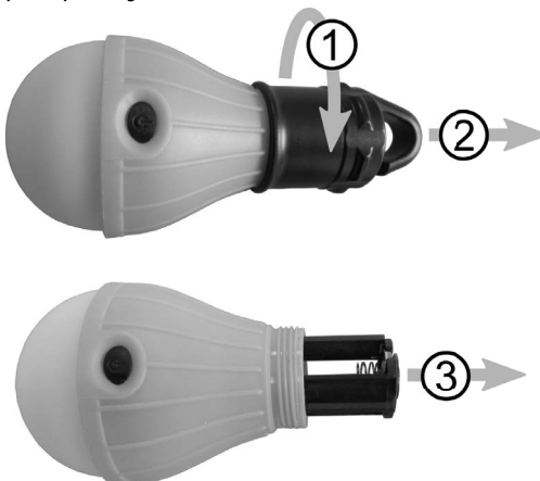
Figure 2 : retirer le porte-piles
