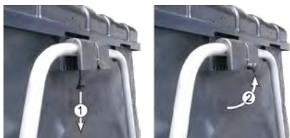
Bild 4: Transportbox am U-Bügel einhängen
