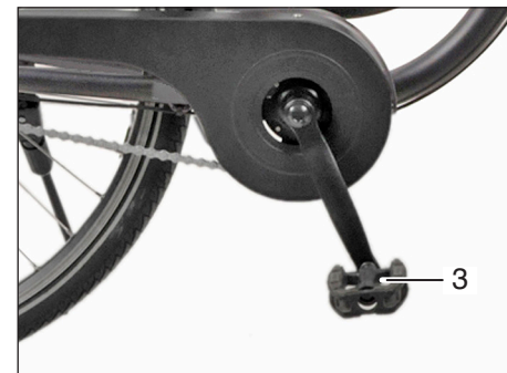
Pedal (3) für Hinterradbremse mit Rücktrittbremse
