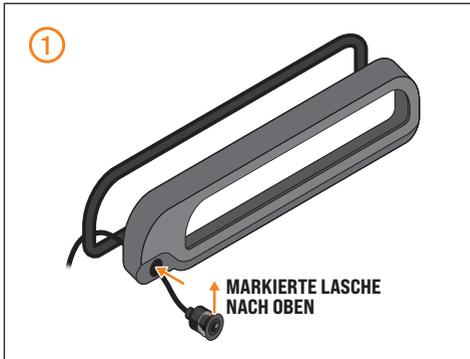
Setzen Sie die **Kamera** mit der markierten Lasche nach oben in die runde Öffnung der Konsole ein. Die markierte Lasche hilft Ihnen dabei die **Kamera** noch vor dem Anschluss grob auszurichten. Sollte die **Kamera** zu locker sitzen, können die Metalllaschen seitlich an der **Kamera** vorsichtig etwas aufgebogen werden.
