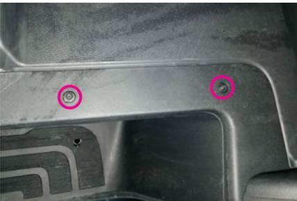
Drehen Sie die zwei Schrauben (Torx 20) im Beifahrerfußraum heraus und nehmen Sie die Verkleidung in L-Form ab.
