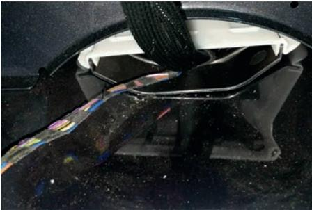
Legen Sie den Subwoofer-Leitungssatz unter die Metallverkleidung und durch die Kunststoffdurchführung in den Beifahrersitzkasten.
