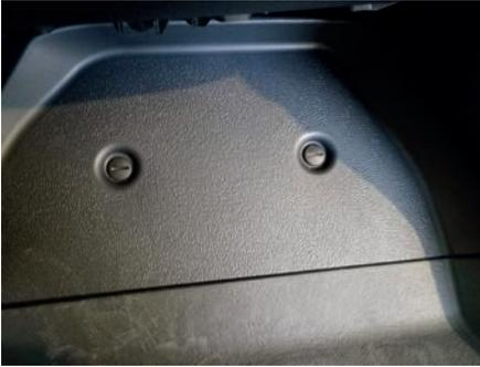
Lösen Sie die Verriegelungsschrauben im Beifahrerfußraum und nehmen Sie die Abdeckung für das Werkzeugfach ab.
