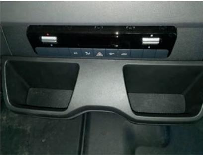
Nehmen Sie das Ablagefach in der Mittelkonsole heraus. Hebeln Sie an beiden Seiten vorsichtig mit einem Kunststoffkeil.
