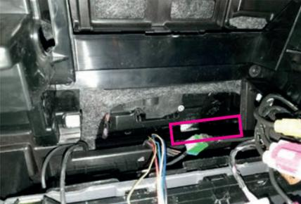
Führen Sie den 20 poligen Stecker des mitgelieferten Leitungssatzes durch den Spalt bis unter das Ablagefach.
