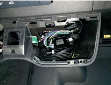
Sichern Sie den Verstärker außerdem mit dem beiliegenden Klettband gegen Verrutschen.
