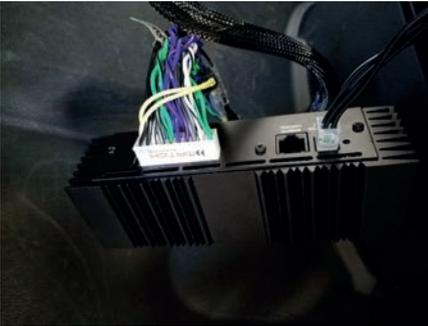
Schließen Sie den Verstärker an und verstauen ihn unter dem Ablagefach in der Mittelkonsole.
