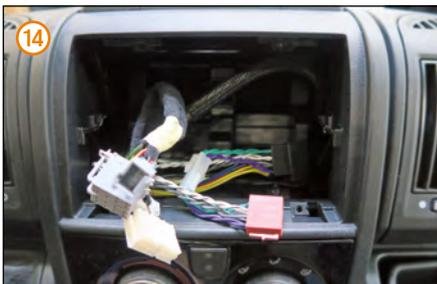
ISO-Leitungen in den Radioschacht legen.
