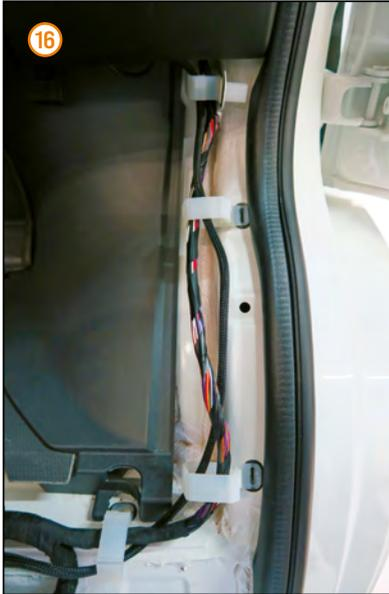
Dazu vorhandenen Kabelkanal nutzen und die Leitung durch die Klammern führen
