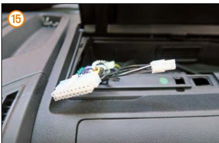
4-polige Subwooferleitung vom Einbauort des Verstärkers hinter dem Handschuhkasten zum Raum unterhalb des Beifahrersitzes verlegen.
