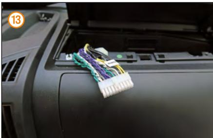
ISO-Leitungssatz vom Radioschacht zum Einbauort des Verstärkers hinter dem Handschuhkasten verlegen.
