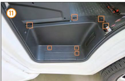
Trittstufenverkleidung auf der Beifahrerseite entfernen, dazu vier Abdeckungen lösen, die darunter befindlichen Kreuzschlitzschrauben entfernen sowie drei Kreuzschlitzschrauben unten entfernen. Ggf. die untere Kreuzschlitzschraube der B-Säulenabdeckung entfernen. Je nach Modell kann es erforderlich sein, modellspezifische Verkleidungen zu entfernen.
