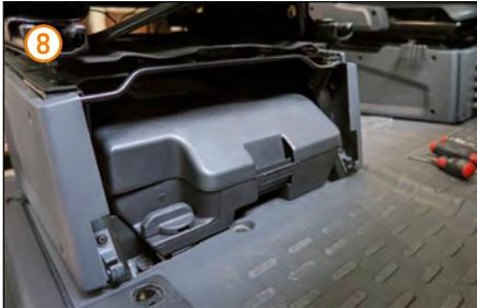
Werkzeugbox entfernen, dazu Verriegelung lösen.
