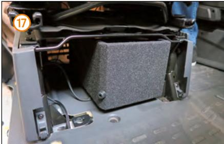
Leitung unter der Bodenverkleidung entlang, unter den Beifahrersitz verlegen, in den Subwoofer einstecken und diesen unter den Sitz schieben.
