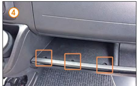
4 Unteren Handschuhkasten entfernen, dazu insgesamt sechs Torx Schrauben entfernen:
