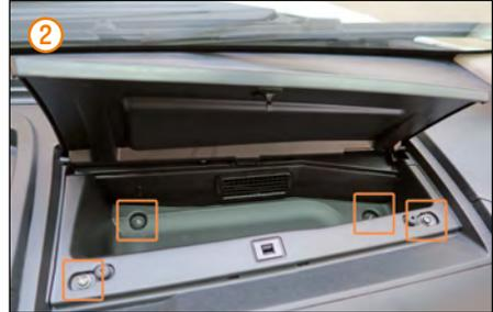
2 Oberes Handschuhfach entfernen, dazu vier Torx-Schrauben lösen.
