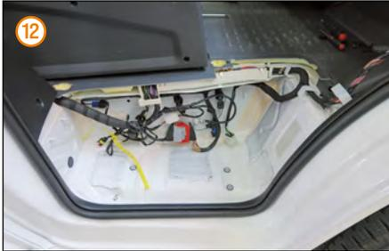
Trittstufenverkleidung herausnehmen. Je nach Modell kann es erforderlich sein, modellspezifische Verkleidungen zu entfernen.
