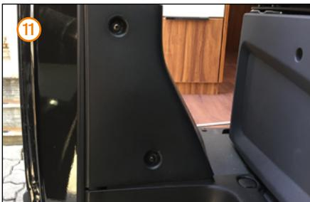
Die Verkleidung der B-Säule auf der Beifahrerseite unten entfernen, um an den weißen 6-poligen Stecker der Radiovorbereitung zu gelangen. Dieser befindet sich unterhalb des Steckers der Aufbau-schnittstelle. Bei einigen Fahrzeugen (z.B. Vollintegrierte Wohnmobile von Knaus) kann dieser Stecker auch unter den Beifahrersitz verlegt worden sein.
