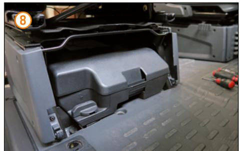
Werkzeugbox entfernen, dazu Verriegelung lösen.
