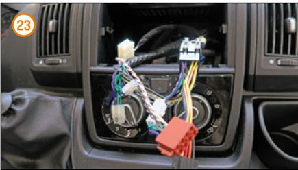
23 Leitung zum Verstärker mit den ISO-Steckern des Fahrzeugs verbinden.
