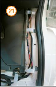
21 4-polige Subwooferleitung vom Einbauort des Verstärkers hinter dem Handschuhkasten zum Raum unterhalb des Beifahrersitzes verlegen.
