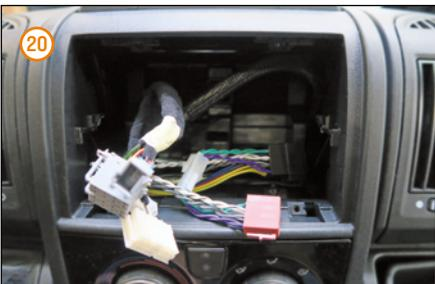
ISO-Leitungen in den Radioschacht legen.
