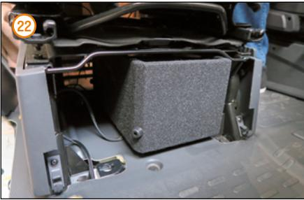
22 Leitung unter der Bodenverkleidung entlang, unter den Beifahrersitz verlegen, in den Subwoofer einstecken und diesen unter den Sitz schieben.
