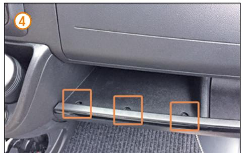
Unteren Handschuhkasten entfernen, dazu insgesamt sechs Torx Schrauben entfernen:
