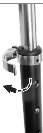
Öffnen Sie den Schnellverriegelungshebel und schieben die Lenkstange ein, indem Sie den Kickverschluss eindrücken.
