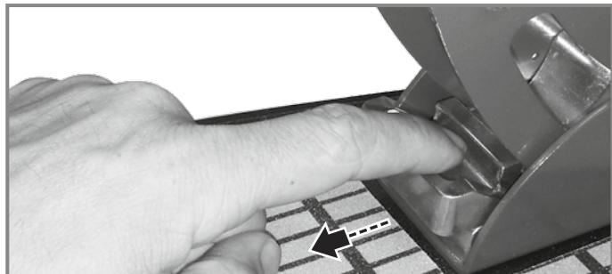
Tirez le chariot du mécanisme de pliage vers l'arrière en direction de la roue arrière. Vous pouvez maintenant plier le guidon vers le haut.
