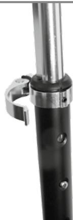
Öffnen Sie die Schnellverriegelung und ziehen Sie die Lenksäule heraus, bis die automatische Sperre einrastet. Schließen Sie anschließend die Schnellverriegelung wieder.
