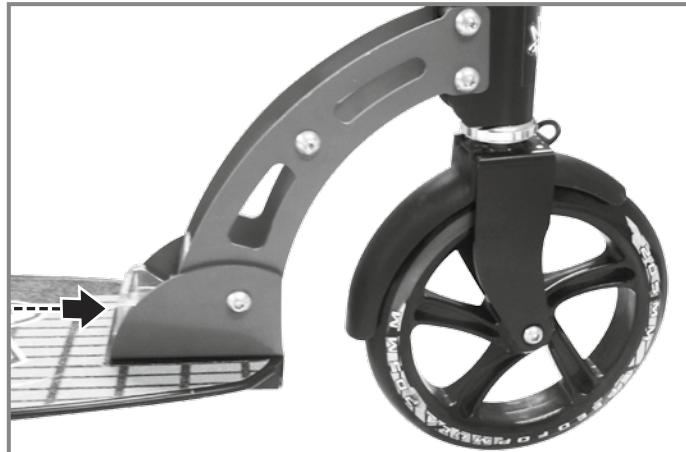
Se lo scooter è stato completamente aperto, il carrello è scattato di nuovo automaticamente in posizione. Si prega di controllarlo prima della partenza.
