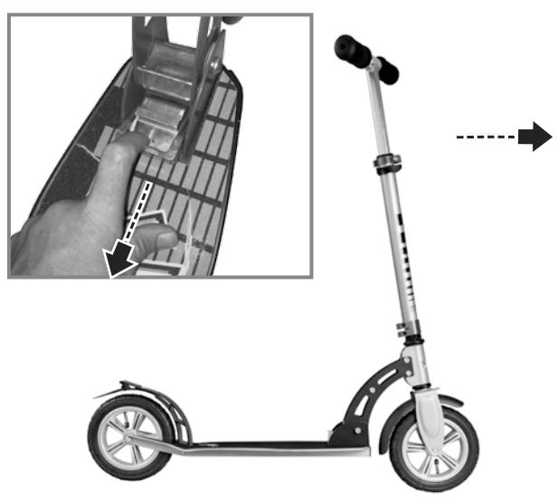
Drücken Sie die Lenkerstange nach vorne und ziehen Sie dann den Schlitten in Pfeilrichtung nach hinten. Klappen Sie anschließend den Scooter wieder zusammen.
