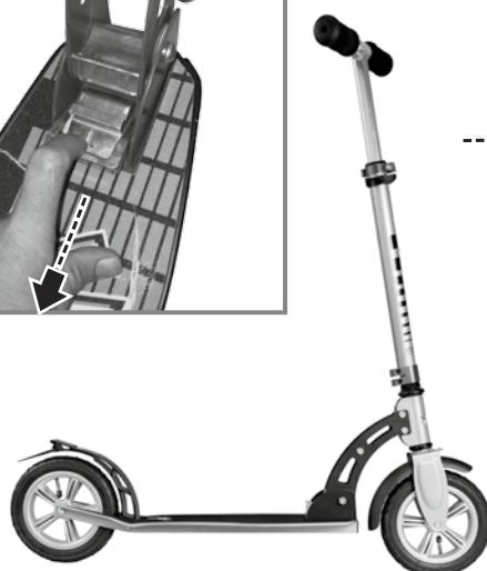
Poussez le guidon en avant, puis tirez le chariot dans la direction de la flèche vers l'arrière et repliez ensuite la trottinette.
