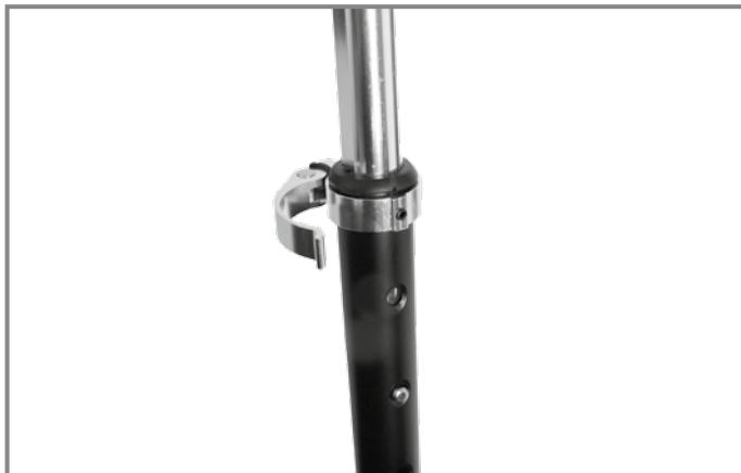
Aprire il blocco rapido ed estrarre la colonna del manubrio finché la barriera automatica non scatta in posizione. Richiudere successivamente il blocco rapido. Anche la tensione ai morsetti del blocco rapido può essere regolata stringendo o allentando il dado di sicurezza.
