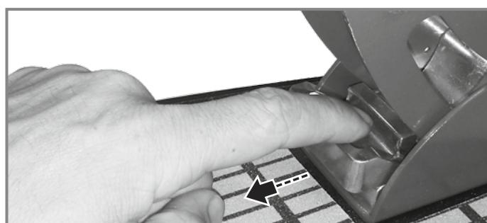
Ziehen Sie den Schlitten des Klappmechanismus nach hinten in Richtung Hinterrad. Nun können Sie den Lenker nach oben klappen.
