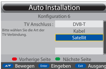
Bild 24 Erstinstallation - TV-Verbindungsart wählen
